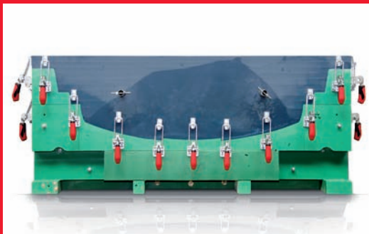
RIM-Werkzeug aus CNC-gefrästem Ureol Kunststoffblockmaterial für die Produktion von Front-Stoßfängern Abmessungen: 2200 x 800 x 600 mm
