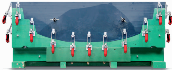
RIM-Werkzeug aus CNC-gefrästem Ureol Kunststoffblockmaterial für die Produktion von Front-Stoßfängern Abmessungen: 2200 x 800 x 600 mm
