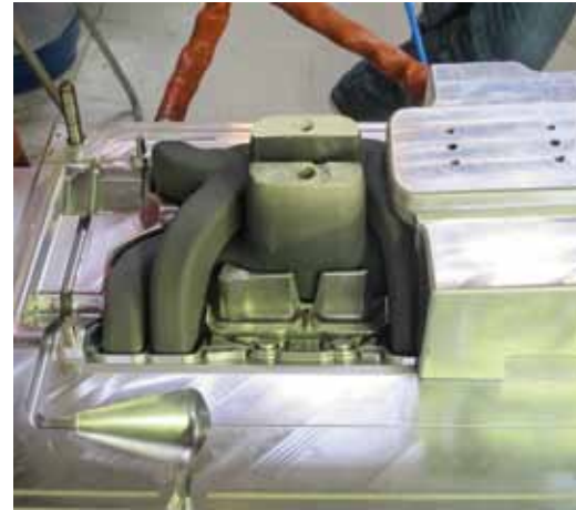
Diese 2-Ebenen-V8-Sauganlage war Anlass für die RPM-Entwicklungsabteilung, das Herstellungsverfahren für Prototypen in der Kleinserienfertigung zu optimieren. Unten: Das Kleinserienwerkzeug als Festwerkzeug mit eingelegten Kernen
