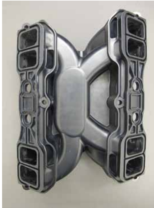
Diese 2-Ebenen-V8-Sauganlage war Anlass für die RPM-Entwicklungsabteilung, das Herstellungsverfahren für Prototypen in der Kleinserienfertigung zu optimieren. Unten: Das Kleinserienwerkzeug als Festwerkzeug mit eingelegten Kernen
