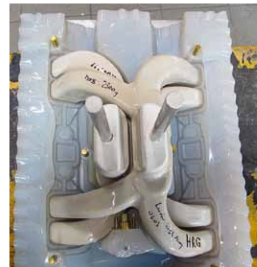
Der Kern für eine V8-Sauganlage in einem Silikon-Gießwerkzeug wird positioniert
